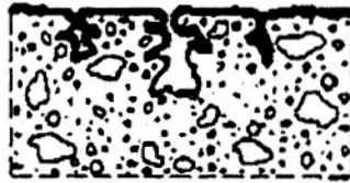
Hình 2 - Sơ đồ thấm thâm nhập điển hình
