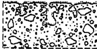
Hình 1 - Sơ đồ thấm kỵ nước điển hình
